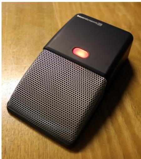
Bei den Mikrofonen entschieden wir uns zusammen mit dem Kunden für eine Neuentwicklung aus dem Haus **Beyerdynamic**. Drahtlose Grenzflächenmikrofone, digital übertragen und verschlüsselt, mit der Produktbezeichnung **Stegos** waren die Wahl. Insgesamt acht Stück stellen die vollkommen flexible Tonaufnahme im Raum von allen wichtigen Beteiligten sicher.
