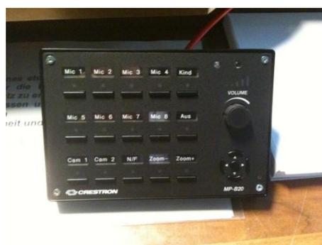
Wir entschieden uns dafür, dem Richter ein einfaches Tastenfeld an die Hand zu geben, mit dem er wichtige Funktionen bedienen kann. Basis der Steuerung ist ein System von **Crestron**. Zusätzlich entwarfen wir eine Touchscreenoberfläche, welche erlaubt, beide VK Systeme von einem Touchpanel aus im Haus zu
