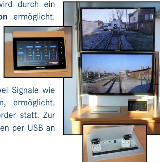
Eine Bild-in-Bild Darstellung wird durch einen Bildprozessor, der zwei Signale wie bspw. Kamerabild und Zuginformationen zusammenführen kann, ermöglicht. Zusätzlich findet eine Aufzeichnung auf einem SSD-Festplattenrecorder statt. Zur weiteren Auswertung und Analyse der Daten können diese Festplatten per USB an weitere Geräte angeschlossen werden.
