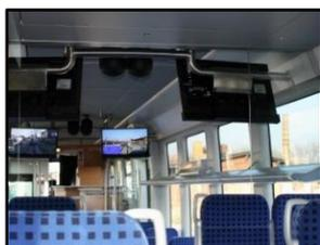
Die Beschallung des Zuges wurde ebenfalls teilweise erneuert. Im Präsentationsbereich sind vier Full-Range Lautsprecher von **JBL** montiert. Über die Länge des Zuges verteilt sind Deckenlautsprecher installiert. Diese können in mehrere Zonen aufgeteilt, und einzeln geregelt, werden. Audioquellen sind bequem über die Tischanschlussfelder anschließbar.
